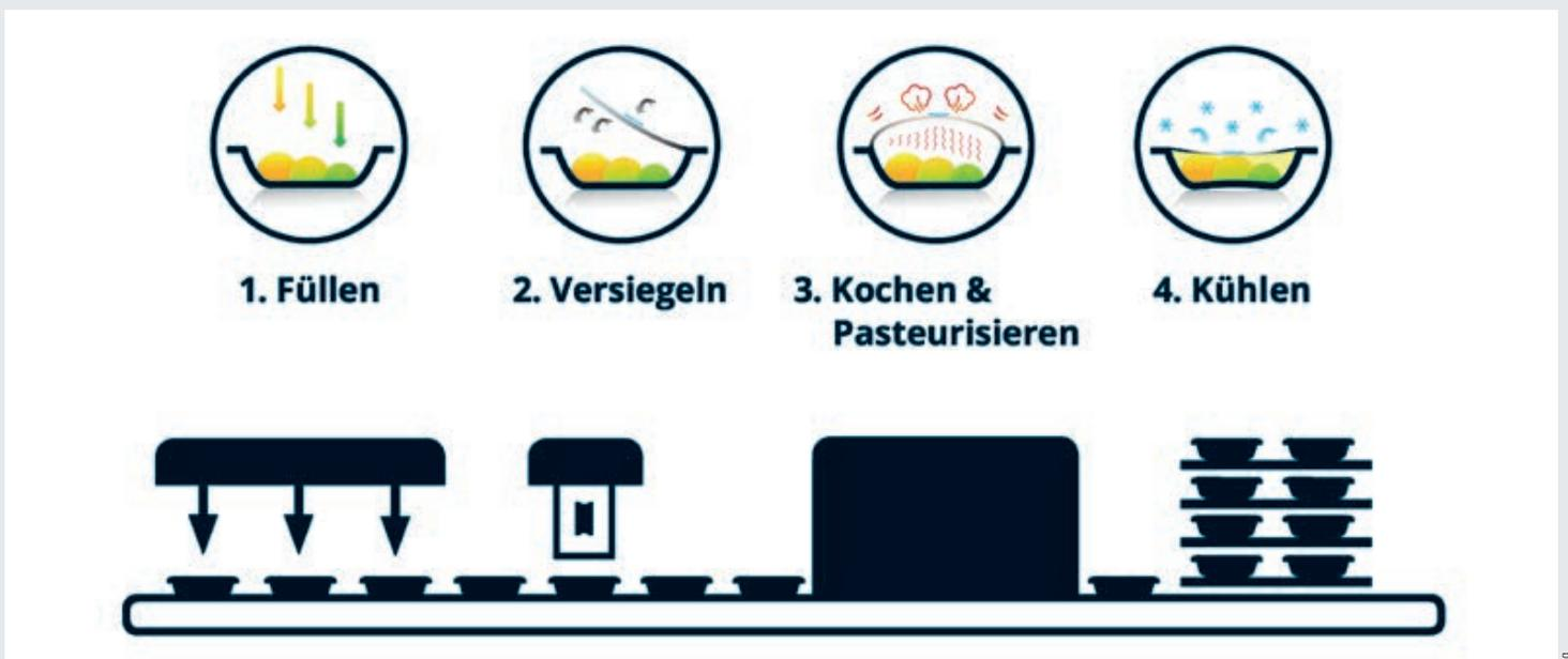
Produktionsfluss für das Micvac-Verfahren. *Flux de production pour le procédé Micvac.*
